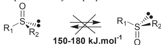
Figure 4.1 - Barrière d'inversion de la configuration d'un sulfoxyde bloquant la racémisation
